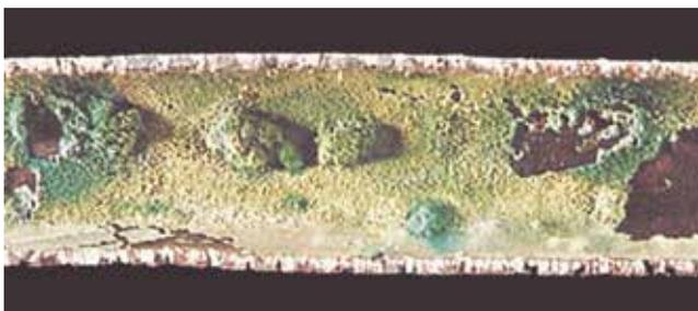
...stumpfe Gewindeschneidkluppen zerstörten das Gefüge im Rohr - feinste Risse waren ungeschützt und die Korrosion begann...
