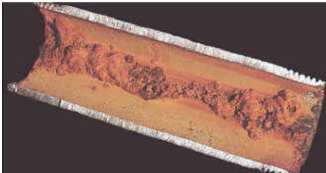
...Erosionskorrosion durch Sand...
